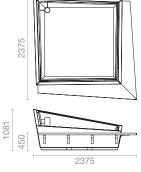
Substrate vol.: 800 l. Water vol.: 136 l.
